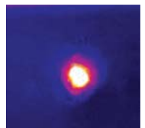
Imagen por infrarrojos de una aguja con punta de broca durante la introducción
